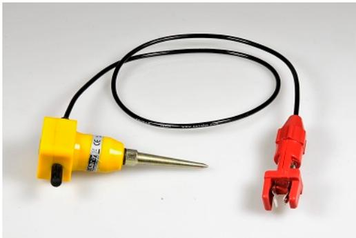
I geofoni verticali utilizzati possiedono una frequenza di risonanza pari 4,5 Hz con distorsione inferiore allo 0,2%.
